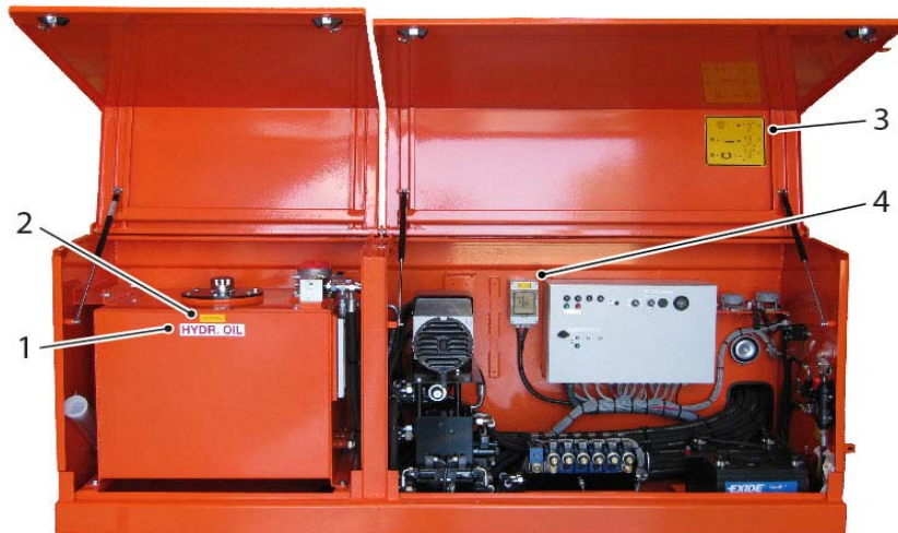
Hydrauliekolie- en ventielen/elektracompartiment
